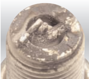
Dépôts résiduels d'huile Depósitos de cenizas aceitosas
