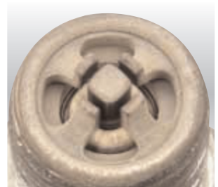
Traces de cheminement de l'isolant Formación de trayectorias en la nariz
