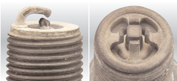
Usure totale Desgastada
