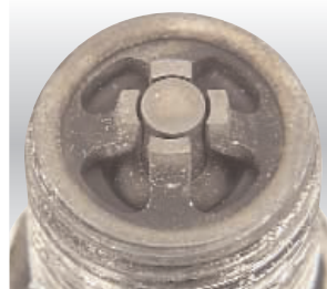
Calaminage Cubiertas de carbón
